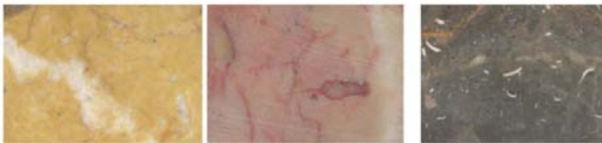
FIGURA 3: FOTOGRAFÍAS MACROSCÓPICAS DE LA CALIZA LOCAL DE TARRACO EN SUS VARIEDADES LLAMADAS «PIEDRA DE SANTA TECLA» (IZQUIERDA Y CENTRAL) Y «LLISÓS» (DERECHA). (Fotos: UEA-ICAC)
