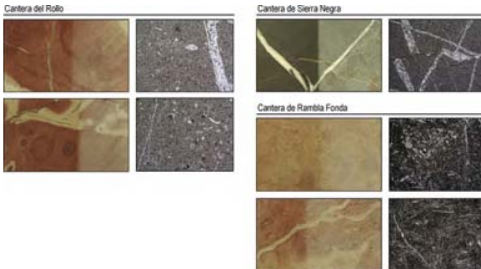
FIGURA 4. IMÁGENES A MESOESCALA Y MICROESCALA DE LAS VARIEDADES HISTÓRICAS DE CALIZAS MASIVAS EXPLOTADAS EN LAS CANTERAS DEL MEDIO VINALOPÓ. LAS MUESTRAS DE MANO POSEEN DOS TIPOS DE ACABADO: PULIDO (IZQUIERDA) Y AL CORTE (DERECHA). Autor de las imágenes: Javier Martínez Martínez
