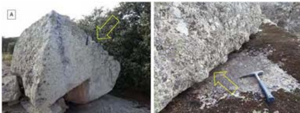
FIGURA 7. ÁREA NE, SECTOR S. A: EXPLOTACIÓN DE BLOQUE GRANÍTICO «IN SITU» CON LAS SUPERFICIES DE CORTE Y LAS MARCAS Y DIMENSIONES DE CUÑAS EMPLEADAS, B: BLOQUE VOLCADO PROCEDENTE DE LA EXPLOTACIÓN DE UNO DE LOS BOLOS, CON LAS IMPRONTAS DE LAS CUÑAS EMPLEADAS EN EL LADO INFERIOR. Fotos: los autores
