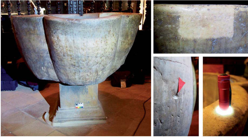
Figura 4.1. Vista general de la pila (izquierda); detalle del color original —visible en una zona limpia y en el punto de extracción de la muestra— y de la translucidez del mármol (derecha).
