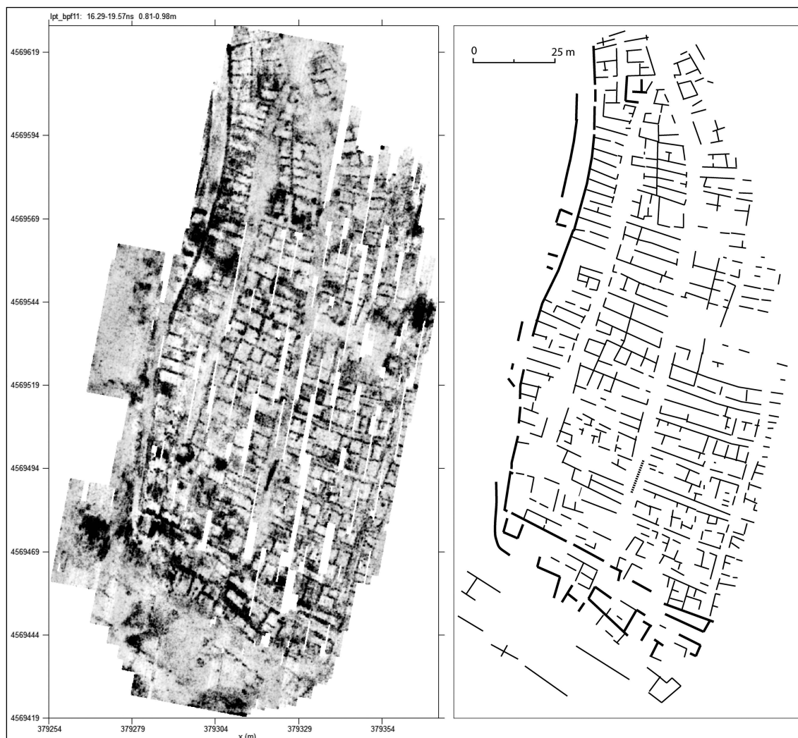
Figura 13. Imagen de la prospección con georadar en el corte horizontal situado entre los 0,81 y los 0,98 metros de profundidad, y plasmación de las anomalías en una planta vectorial (elaboración propia).
