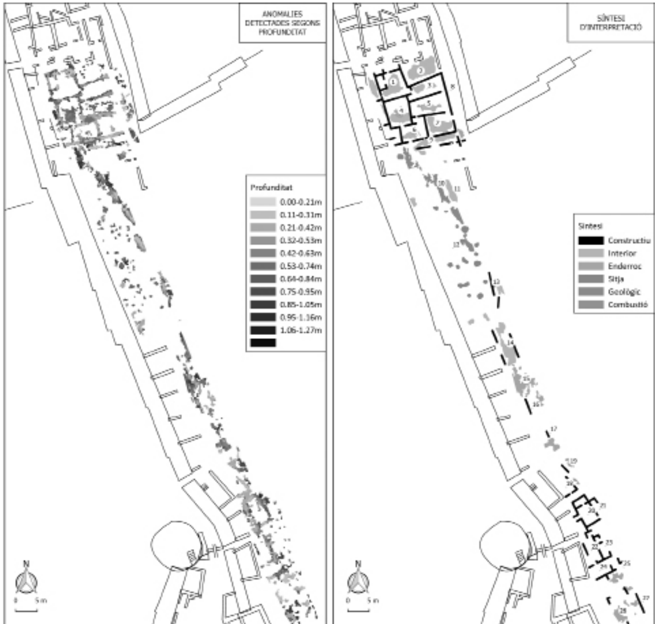
Figura 6. Esquemes d'interpretació de les dades de georadar. A l'esquerra, esquema d'interpretació per profunditats, on es mostren les anomalies més destacades segons la seva profunditat. A la dreta, síntesi d'interpretació, on es recullen les interpretacions expressades al text de manera esquemàtica.
