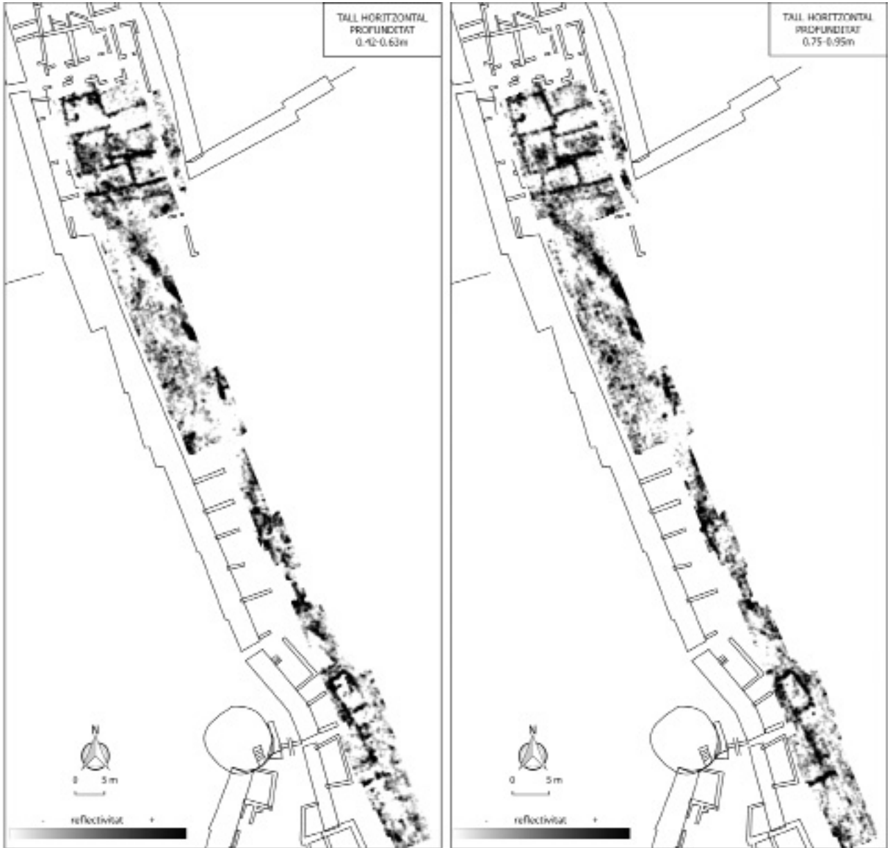
Figura 7. Dos talls horitzontals de la seqüència generada, corresponents a profunditats de 0.42-0.63 m (esquerra) i 0.75-0.95 m sota superfície (dreta).
