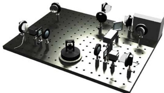
Fig. 5. Sistema de imagen tomográfico en el dominio del tiempo a frecuencia de terahercios
