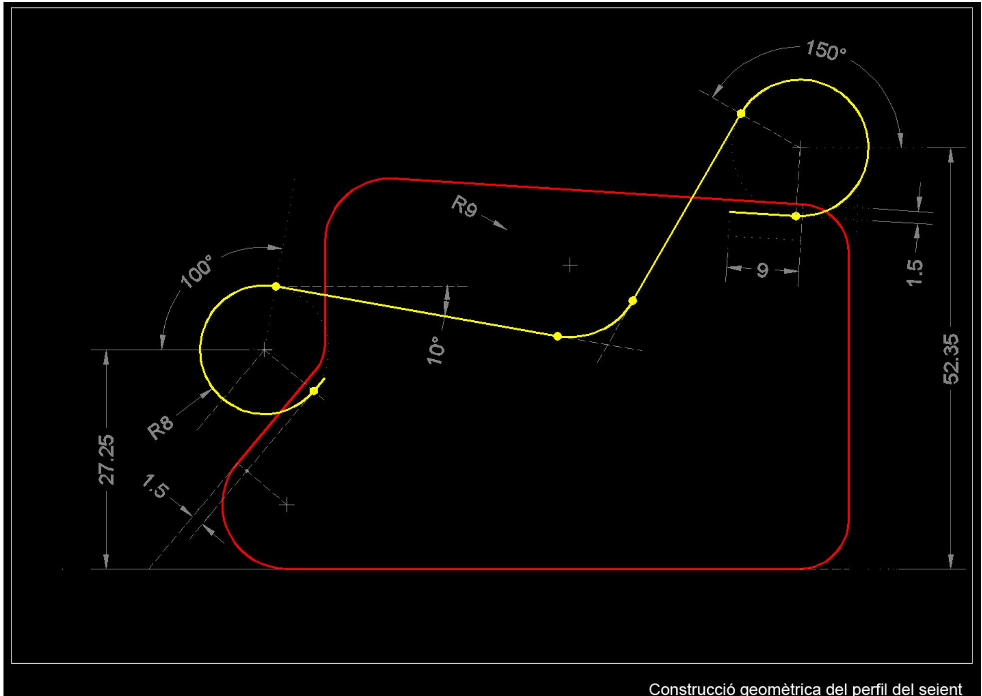
Construcció geomètrica del perfil del seient
