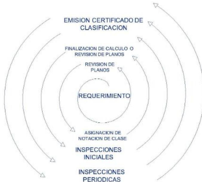
Ilustración 1: Proceso de Clasificación e inspección de embarcaciones marinas (Lina Suárez, 2017).
