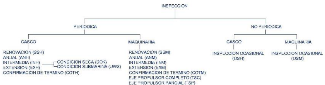
Ilustración 2: Proceso de inspección de clase, alcance de inspecciones. (Lina Suárez, 2017)
