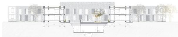
Figura 13. Sección de los espacios comunes enterrados en el antiguo Sanatorio de la Savinosa. Se mantienen los edificios en la roca, se resuelve la accesibilidad y se generan nuevos paisajes y soluciones climáticas.
