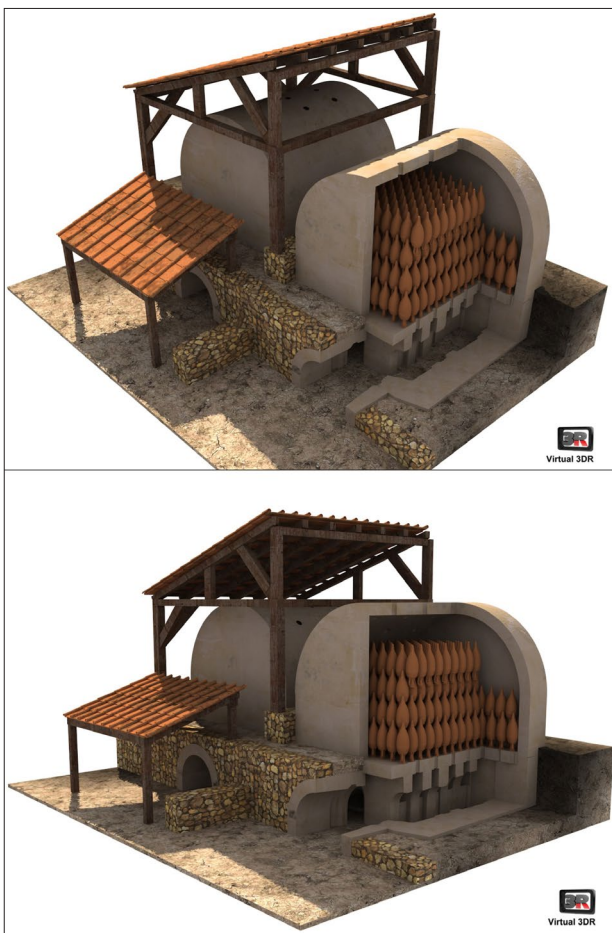
FIGURA 14. Proposta de restitució arquitectònica i funcional del forn de planta rectangular corresponent a la segona fase de producció del taller. Diferents vistes.
