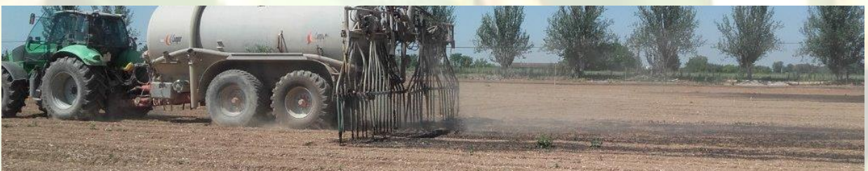
Imatge 3. Aplicació del purí en fons mitjançant cisterna amb tubs penjants. Es recomana enterrar el purí al sòl a les poques hores per evitar pèrdues de nitrogen i emissió d'olors (Imatge: Oficina de Fertilització i Tractament de les dejeccions ramaderes).
