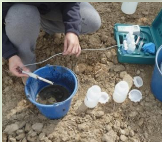
Imatge 2. Mesura de la riquesa del purí mitjançant conductímetre.
