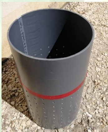
Imatge 1. Piezòmetre per la realització del mètode de regons construït a partir de "Water management in irrigated rice", B.A.M Bouman, R.M Lampayan i T.P Toung.
