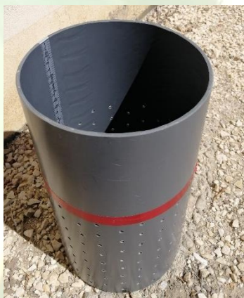
Imagen 1. Piezómetro para la realización del método de riegos construido a partir de "Water management in irrigated rice", B.A.M Bouman, R.M Lampayan y T.P Toung.
