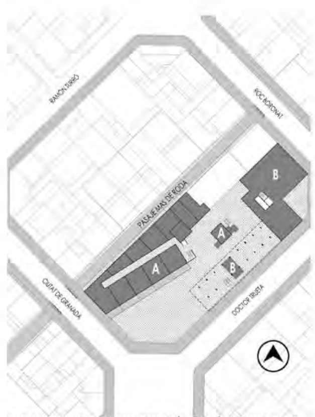
PLANTA BAJA DEL PROYECTO DE REHABILITACIÓN DE LA FÁBRICA CAN GILI VELL. (A) EDIFICIOS REHABILITADOS DESTINADOS A VIVIENDA. (B) EDIFICIOS DE NUEVA PLANTA QUE ALOJAN OFICINAS.
